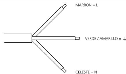
**EL CABLE DE ALIMENTACIÓN ELÉCTRICA SE DEBE COLOCAR DE MODO TAL QUE NO ALCANCE EN NINGÚN PUNTO UNA TEMPERATURA QUE SUPERE EN 50°C LA TEMPERATURA AMBIENTE.**
